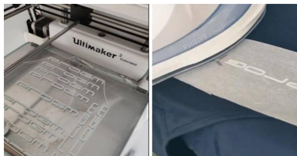
Polókra került logók előállítási módja 3D nyomtatóban, illetve ruhaneműre történő felvitele
